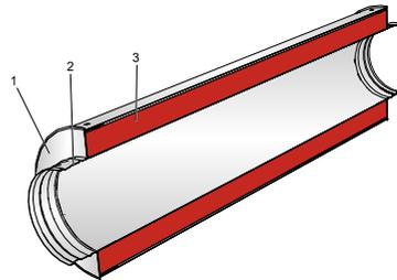
Abb. 4: Schematische Darstellung Rohrschalldämpfer
