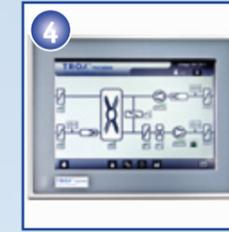
Intuitive Bedienung durch eine übersichtliche Visualisierung der Gesamtanlage auf dem Touch-Panel mit TROX Software.
