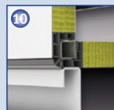
Die schall- und wärmedämmte Gehäusekonstruktion ermöglicht eine durchgängige thermische Entkopplung auch im Bodenbereich.
