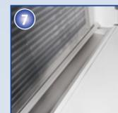
Der Wärmeübertrager zur Kühlung und Entfeuchtung ist mit einer Edelstahl-Kondensatwanne mit allseitigem Gefälle ausgestattet. Die Kondensatwanne wird sowohl im Boden, als auch im Zwischenboden (extra flache Ausführung) eingesetzt. Dadurch wird ein vollständiger Kondensatablauf gewährleistet, und die gesamte Einheit ist leicht zu reinigen.
