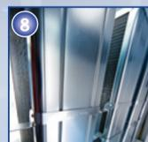
TROX Schalldämpferkulissen mit strömungsgünstig profiliertem Kulissenrahmen erzielen 30 % weniger Druckverluste als herkömmliche Kulissen. Mit variablen Abstandshaltern kann der Kulissenspalt anforderungsgerecht eingestellt werden. Die Abstandshalter dienen gleichzeitig als Griff zum Revisionieren der Kulissen bei der Gerätereinigung.
