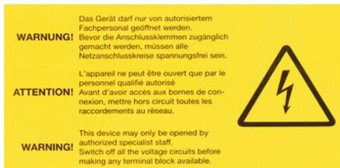
Dieses Schild weist darauf hin, dass der Revisionsdeckel Regelung nur von einer Elektrofachkraft geöffnet werden darf. Bevor die Anschlussklemmen zugänglich gemacht werden, müssen alle Netzanschlusskreise spannungsfrei sein.
