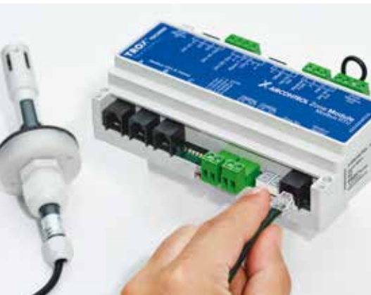
Plug & Play Anschluss von Komponenten
