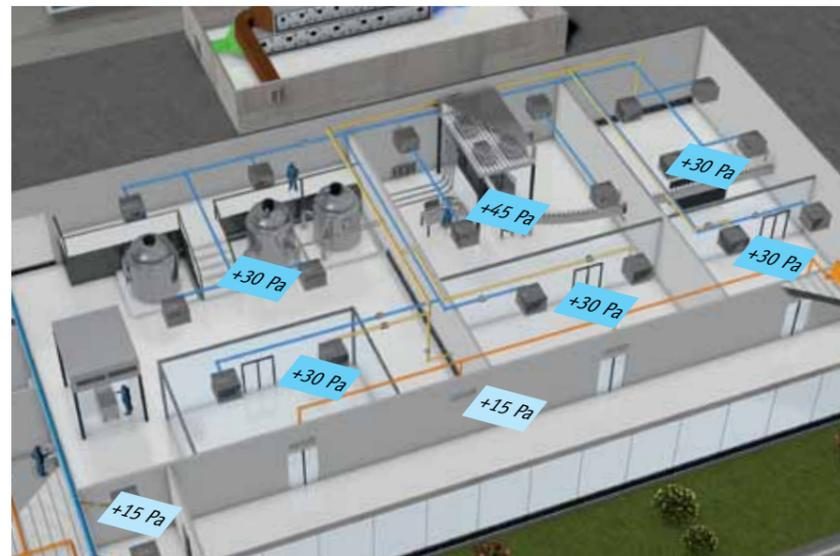
Les zones critiques peuvent être isolées par des moyens précis de contrôle de pression et de régulation de débit d'air.
