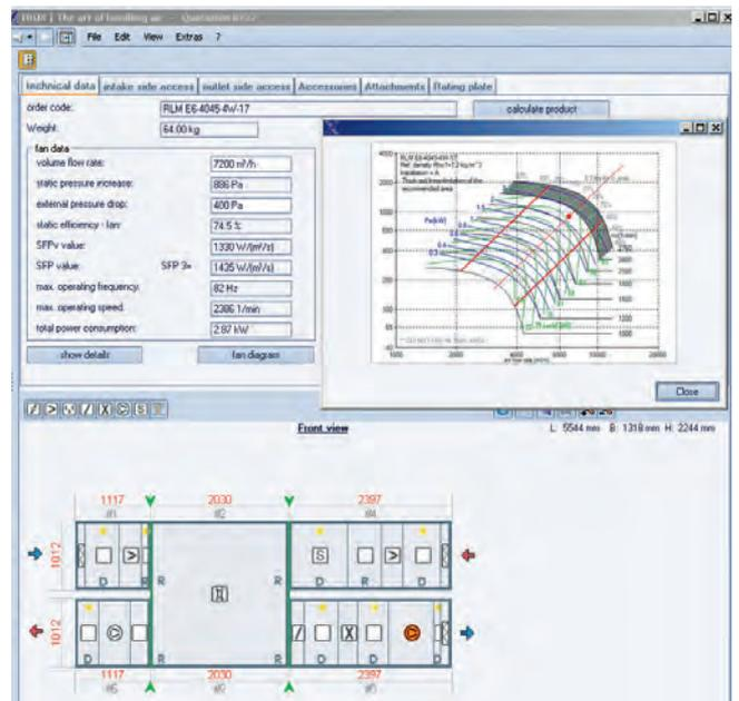
Configuration des centrales de traitement d'air avec le X-CUBE Configurator
