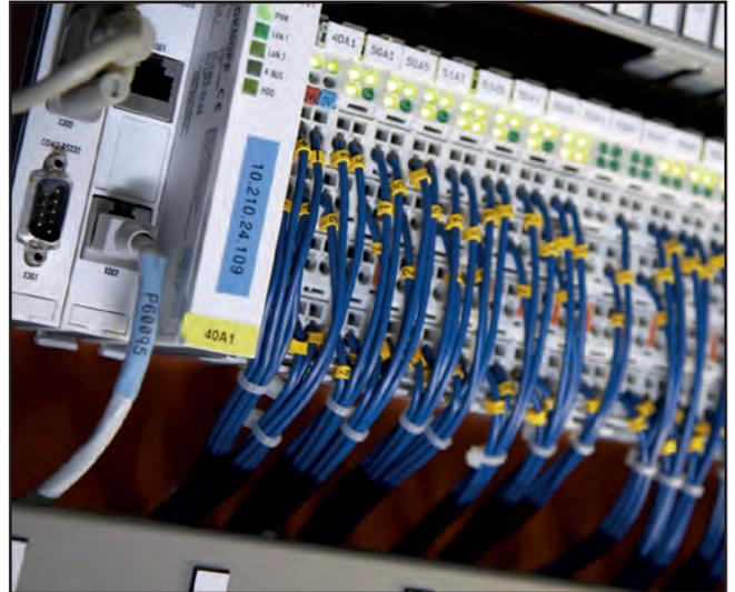
Système de mesure et de contrôle modulaire et évolutif
